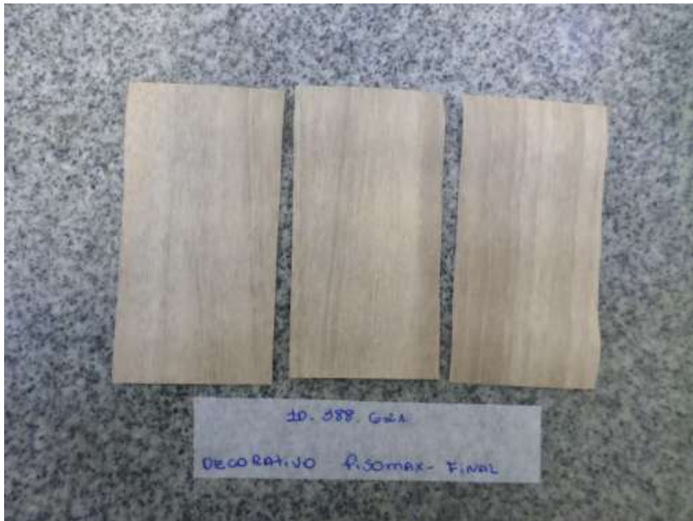
Foto 2. Amostras após 1500 horas de exposição ao intemperismo.
