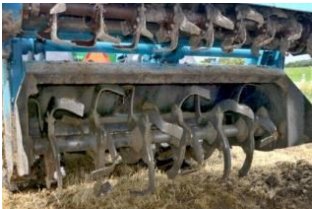
2. De Imants spitmachine werkt dit keer met messen om de grond goed te kunnen breken. Erboven een frees voor de bovengrond.
