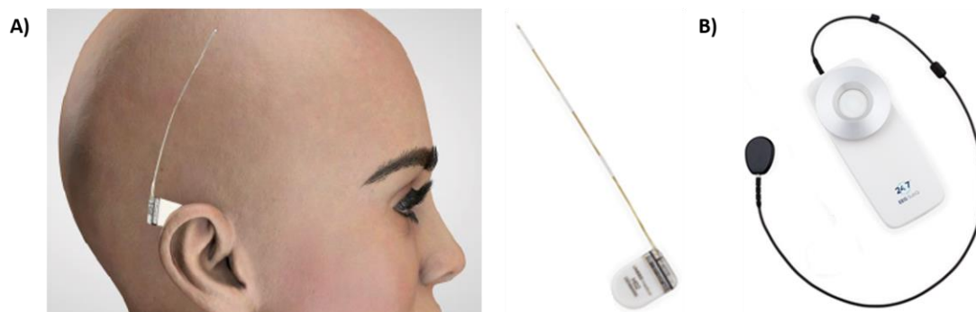
Afbeelding 1: A) EEG elektrode die net boven het oor volledig onder de huid wordt ingebracht. B) Bijbehorende apparaatje dat u draagt en waar de data op wordt opgeslagen.
