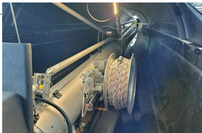
Il sistema di retrazione del cavo di traino, realizzato dalla stessa Lightwing AG.
