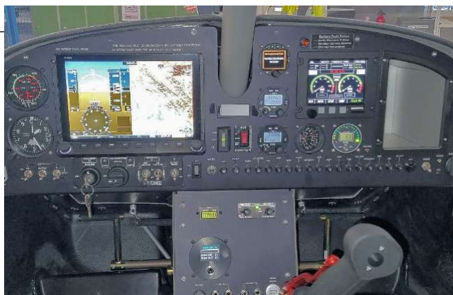
Il pannello strumenti con avionica moderna e schermi video per la visione posteriore.
