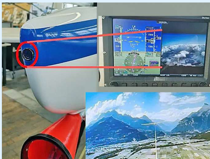
La telecamera di coda e due viste dallo schermo in abitacolo.
