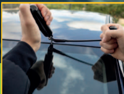
COLTELLO MANUALE DOTATO DI CAVO E SISTEMA FERMA CAVO
