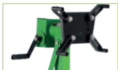
Sistema di rotazione a 360° a manovella
