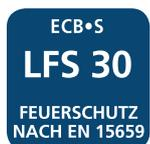
Die Norm EN 15659 regelt die Prüfung von Tresoren auf Feuer-Widerstand. LFS 30 garantiert einen Schutz von mindestens 30 Minuten für Papier.
