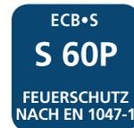
Die Norm EN 1047-1 regelt die Prüfung von Tresoren auf Feuer-Widerstand inklusive Sturzttest. S 60P garantiert einen Feuerschutz von mindestens 60 Minuten auf Papier.
