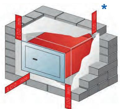
**Die Ummantelung mit Beton schützt vor dem gewaltsamen Herausbrechen des Wandtresors. An allen Seiten sollte der Tresor von einer 100 Millimeter starken Betonschicht umgeben sein.**
