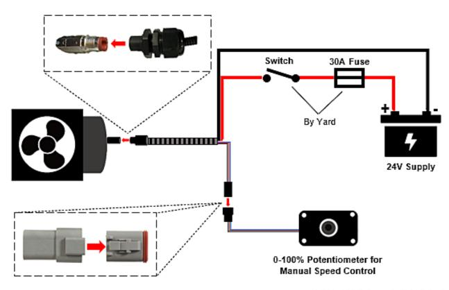
!! ENSURE A 30A FUSE IS PLACED IN THE CIRCUIT BETWEEN THE POSITIVE POWER SUPPLY AND THE POSITIVE TERMINAL OF THE MOTOR (BEFORE THE SWITCH) !!
