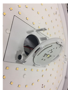
Abbildung ausrichtbares Notleuchtmittel (klappbar/justierbar speziell bei Wandmontage)
