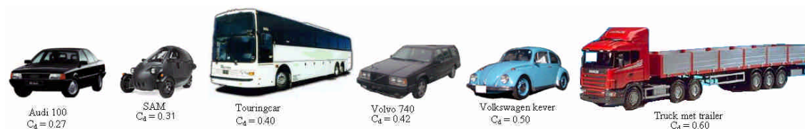
Figuur 55 "Cd" waarden (luchtwrijvingsweerstandscoefficienten) van frontale oppervlakken van verschillende voertuigen
