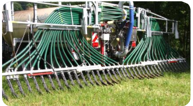
Am Grünland erfolgt die bodennahe streifenförmige Ausbringung von Gülle am häufigsten mittels Schleppschuhtechnik. | BWSB, Franz Xaver Hölzl
