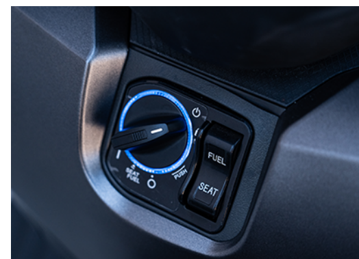
■ Il sistema Keyless avvia lo scooter senza dover inserire la chiave
