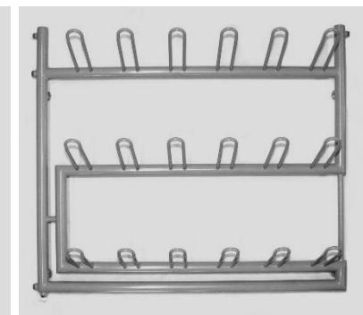
Der **TOBDRY-SCHUHTROCKNER** wird mit warmem, zirkulierendem Wasser beheizt. Das System ermöglicht eine gleichmässige Wärmeverteilung in allen Bügeln und somit ein schnelles Trocknen. Der **TOBDRY** kann sowohl an ein bestehendes Heizsystem angehängt, als auch elektrisch betrieben werden.
