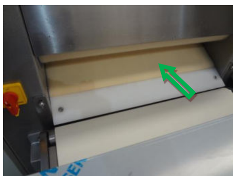
Ferramenta com a proteção aberta
