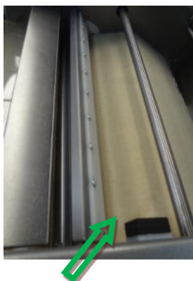
Chave eletromagnética sensor SSM5-30R1PD2A e atuador ASSM5-30RP da marca WEG.
