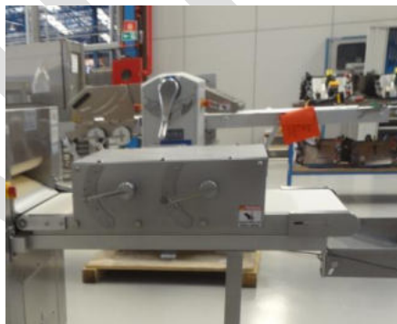
Alavancas de regulagem e escalas de graduação para ajuste de espessura da massa ao passar pela esteira.
