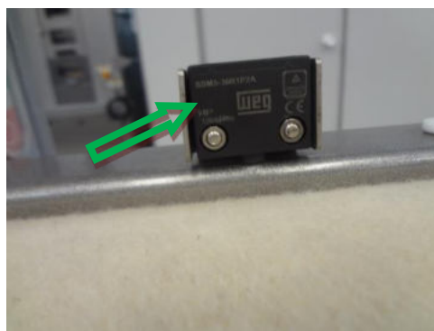
Chave eletromagnética sensor SSM5-30R1PD2A e atuador ASSM5-30RP da marca WEG.
