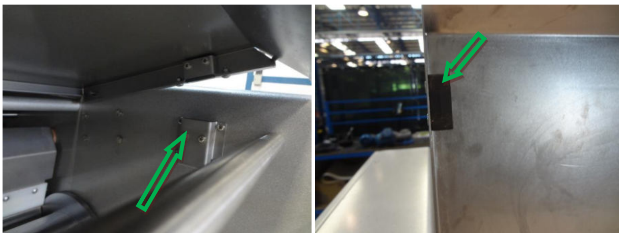
Chave eletromagnética sensor SSM5-30R1PD2A e atuador ASSM5-30RP da marca WEG.
