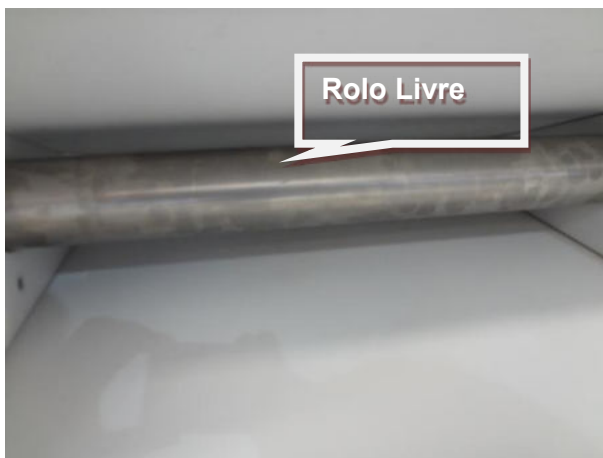
Ferramentas com proteção fechada e rolo livre
