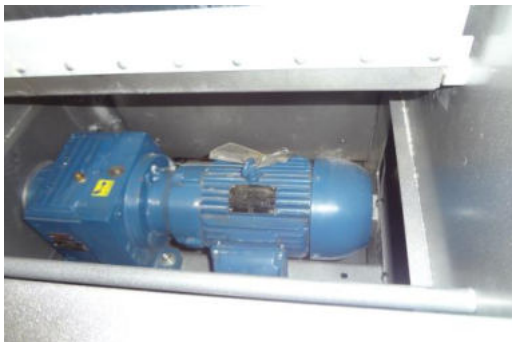
MOTOR BLINDADO E PROTEGIDO POR CARENAGEM FIXA
