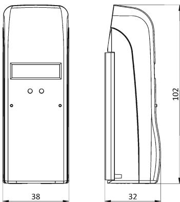
Der EHKV besitzt eine rollierende Anzeige. Für die Abdeckung umbaubedingter Lackfehler am Heizkörper ist eine optische Verlängerung anrastbar. Ein optionaler Fernfühler ist ansteckbar. Die automatische Geräteaktivierung erfolgt durch eine Anbauerkennung.
