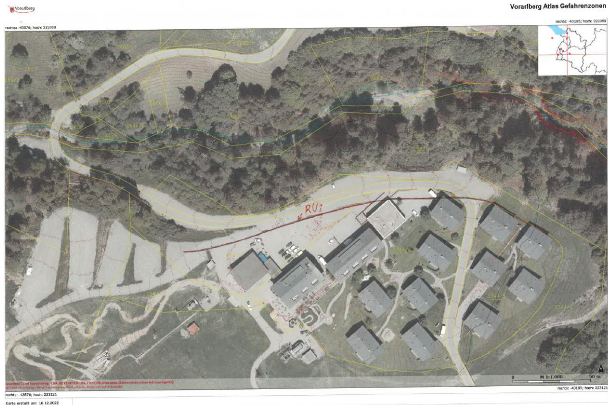
Abbildung 12 Abgrenzung des Rui (intensiv gefährdeter Rutschbereich) im Bereich Landal (Quelle: Gebietsbauleitung Bludenz und Amt der Vorarlberger Landesregierung)
