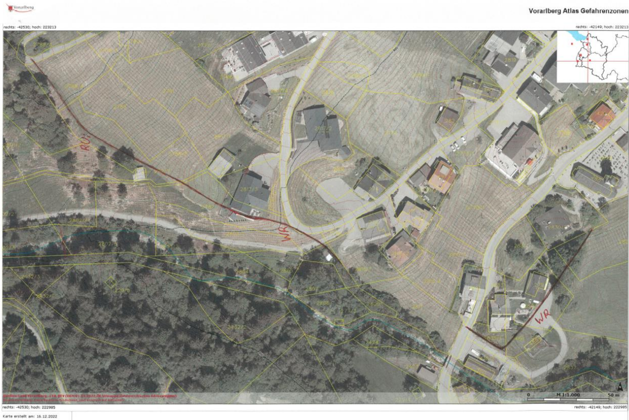
Abbildung 11 Wildbachtechnische und geologische Baugrenze im Bereich Matin West (Quelle: Amt der Vorarlberger Landesregierung und Wildbach- und Lawinenverbauung Baugebietsleitung Bludenz)
