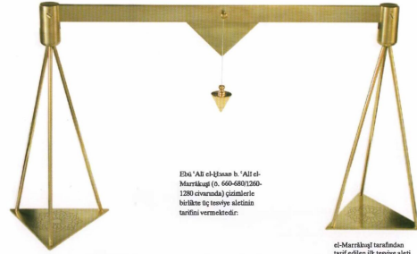
el-Marraküşî tarafından tarif edilen üç tesviye aleti. Modelinin Fotoğrafı, no: 32 cm. (Einvanter No: D.1.28)
