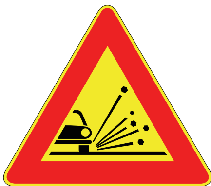
Fig. 390 - 3900 materiale instabile sulla strada
