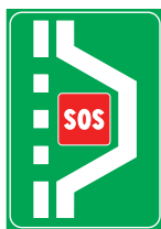
Fig. 329 - 3290 piazzola + sos autostradale
