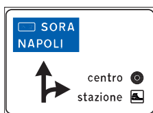
Fig. 233 segnale di preavviso di intersezione urbana
