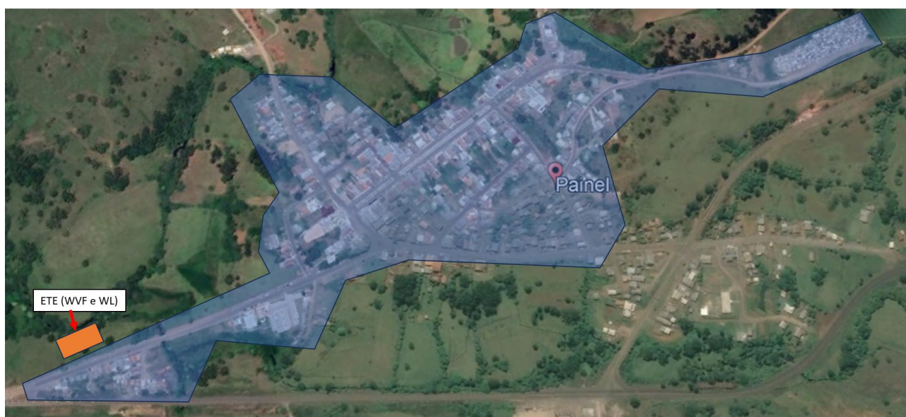
Figura 17 - Bacia de contribuição para o tratamento de esgoto descentralizado e do lodo proveniente dos sistemas individuais.
