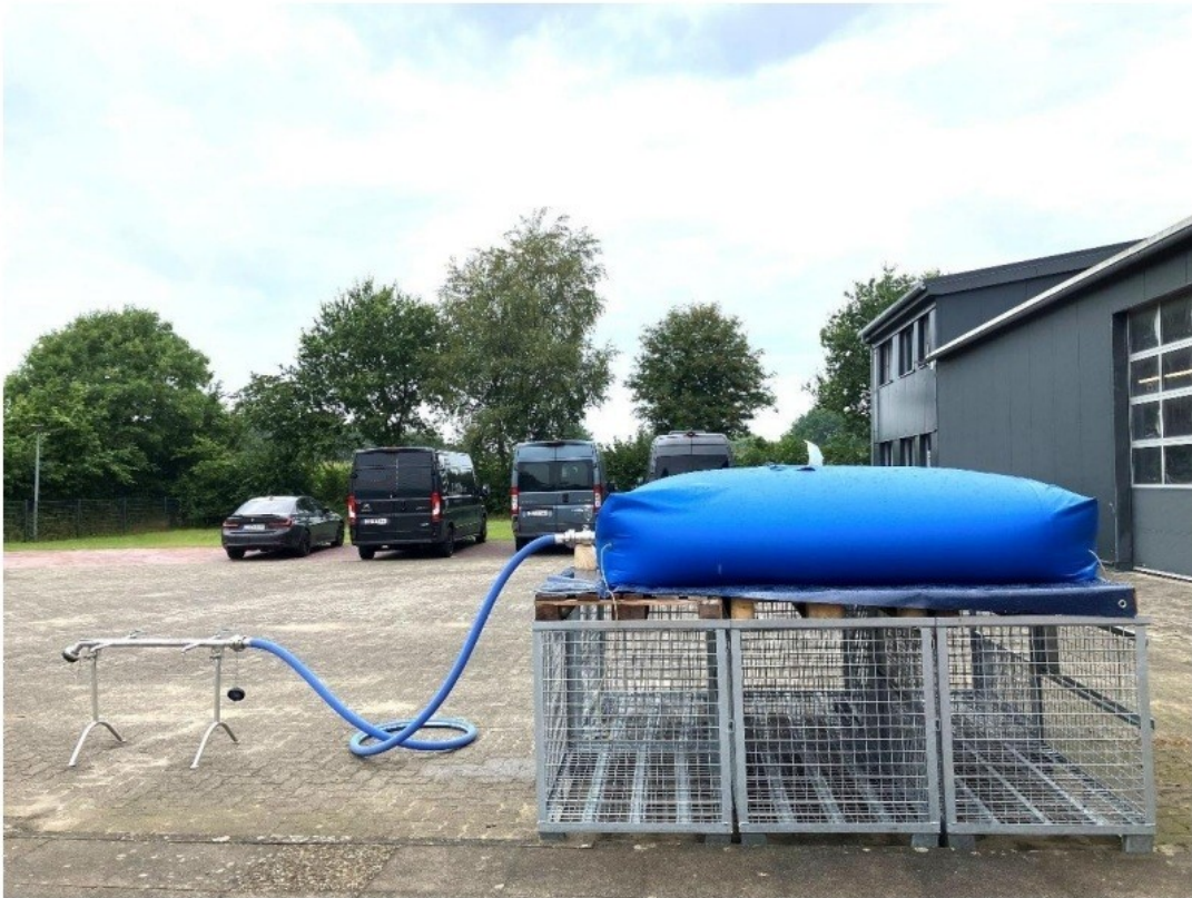
Aufstellfläche für Behälter: mind. 240 x 240 m
