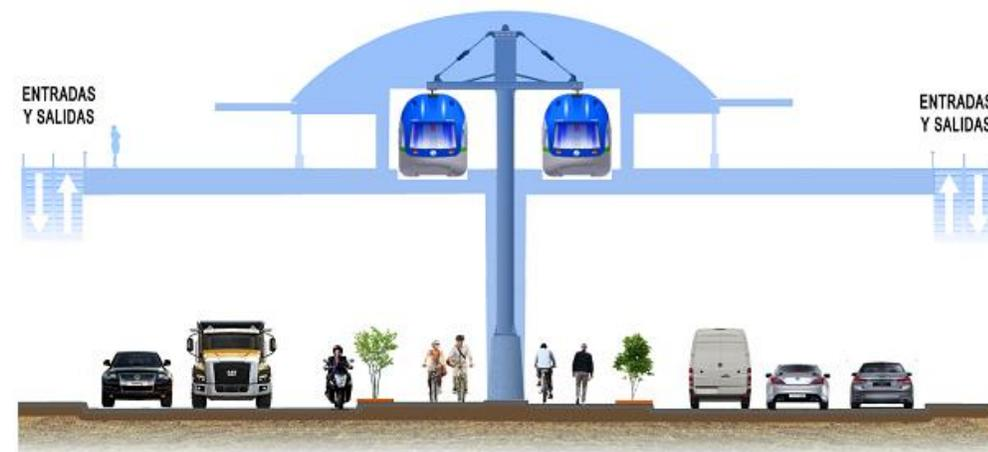
Sección estación y viga vía.
